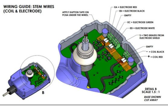
TURN POWER OFF BEFORE REMOVING THE BOARD.
